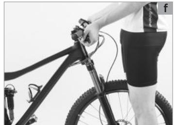
Richten Sie ggf. die Bauteile aus und drehen Sie die Schrauben vorsichtig fest, bis die Bauteile sicher klemmen **(a)**. Die maximalen Schraubendrehmomente finden Sie auf den Bauteilen aufgedruckt oder in den Anleitungen der Komponentenhersteller.
