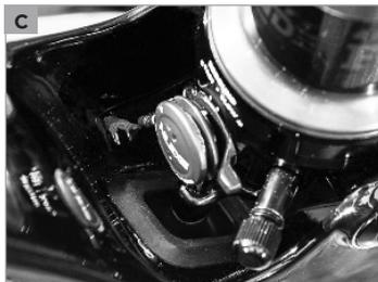
Wenn Sie den „sag“ korrekt wie oben beschrieben eingestellt haben und das Federbein bei einer normalen Probefahrt ordentlich arbeitet, aber dann in Extremsituationen das Federbein dennoch durchschlägt, können Sie die Druckstufendämpfung etwas erhöhen.
