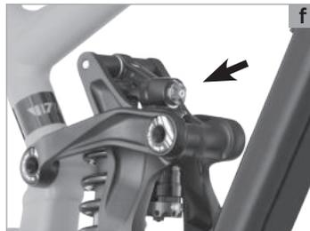
Führen Sie nach jeder Änderung der Einstellung eine Probefahrt durch möglichst vielseitiges Gelände durch. Überprüfen Sie danach die Position des Gummirings/Kabelbinders. Sein Abstand zum Abstreifer ist der maximale Federbeinhub, den Sie genutzt haben.
