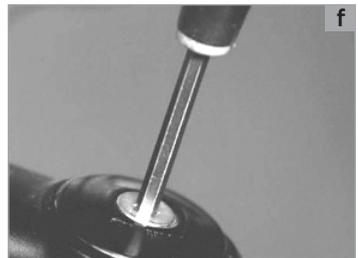
Überprüfen Sie nach der Justage bzw. Montage den sicheren Sitz des Lenkers im Vorbau, indem Sie versuchen, ihn nach unten zu verdrehen **(a)**. Prüfen Sie, ob sich die Lenker-Vorbau-Kombination gegenüber der Gabel verdrehen lässt. Nehmen Sie dazu das Vorderrad zwischen die Knie und versuchen Sie, den Lenker zu verdrehen. Ist das möglich, müssen Sie die Schrauben vorsichtig nachdrehen und den Sitz nochmals überprüfen **(b)**.
