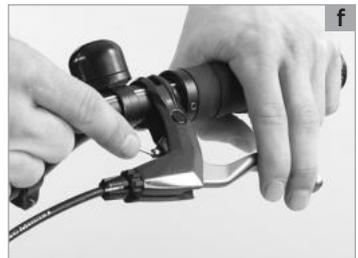
Bei hydraulischen Bremsen befinden sich ebenfalls Verstellrichtungen am Bremshebel **(a)**. Es gibt unterschiedliche Systeme. Fragen Sie Ihren Scott-Fachhändler oder lesen Sie die Anleitungen der Komponentenhersteller.
