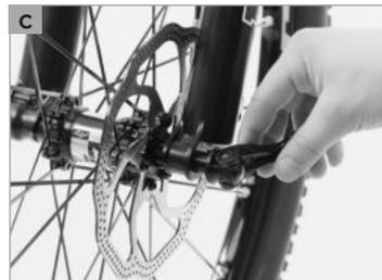
Der Schnellspannhebel darf sich nach dem Schließen nicht mehr drehen lassen. Achten Sie darauf, dass der Schnellspannhebel nicht nach vorne oder außen absteht **(e)**. Am besten wird er vor dem Tauchrohr nahezu senkrecht nach oben geschlossen **(f)**.
