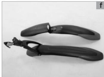
Nachrüstbare Radschützer zum festen Anbringen bestehen in der Regel aus Kunststoff und werden mit Hilfe der zusätzlich angebrachten Streben in der richtigen Position gesichert. Die Länge der Strebe ist dann optimal, wenn die Unterkante des Radschutzes etwa 15 mm entfernt ringförmig parallel zum Reifen verläuft. Achten Sie auch darauf, dass weder Bremsen noch die Lenkung beeinträchtigt werden.
