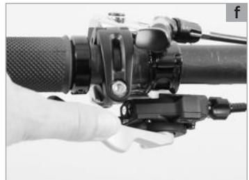
Der kleine Hebel, der aus Sicht des Fahrers vor dem Lenker liegt und mit dem Zeigefinger bedient wird (Zeigefinger-Hebel) **(a)**, bewegt die Kette zu den kleineren Kettenblättern/Ritzeln hin – also rechts in schwerere und links in leichtere Gänge.
