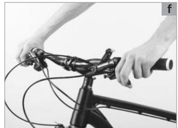
Bei **Scheibenbremsen** muss der Druckpunkt sofort stabil sein. Lässt sich erst nach mehrmaligem Betätigen des Bremshebels ein stabiler Druckpunkt erfüllen, sollten Sie Ihr Scott-Bike sofort bei Ihrem Scott-Fachhändler überprüfen lassen.
