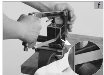
6. Drehen Sie den Expander mit einem 8 mm Innensechskantschlüssel mit einem Drehmoment von maximal 4-5 Nm an. Vergewissern Sie sich, dass der Expander bündig mit der Oberkante des Schaftrohres abschließt **(a)**. Stellen Sie sicher, dass der Abstand zwischen der Oberkante der Vorbauklemme und der Oberkante des Schaftrohres nicht mehr als 2,5 mm beträgt, siehe Abbildung.
